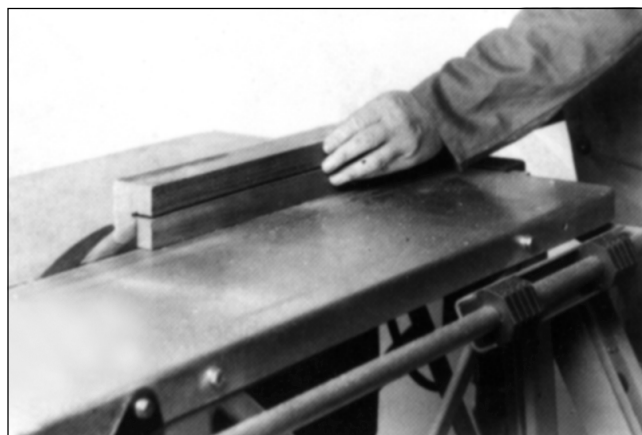
D Les différentes coupes doivent être choisies de façon à ce que la partie découpée se trouve à gauche de la lame.
